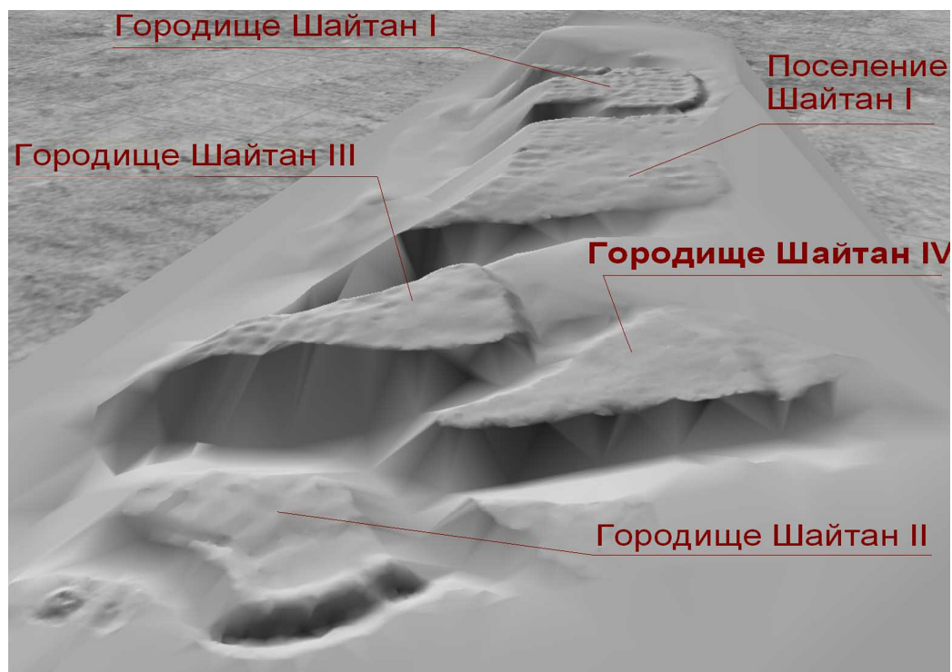
Рис. 1. Построенная на данных тахеометрической съемки цифровая модель рельефа городищ Шайтанского археологического микрорайона
