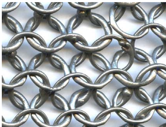
Рис. 2. Фрагмент кольчатого «полотна» панциря (без масштаба, фото Ю. А. Филипповича)
