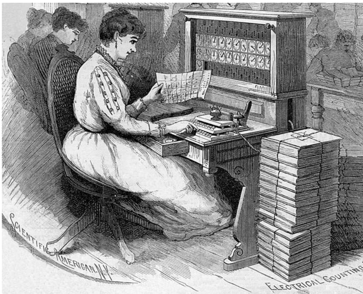
Электромеханический табулятор Германа Холлерита (Herman Hollerith // United States Census bureau. URL: http://www.census.gov/history/www/census_then_now/notable_alumni/herman_hollerith.html / Дата обращения: 12.04.2012)
