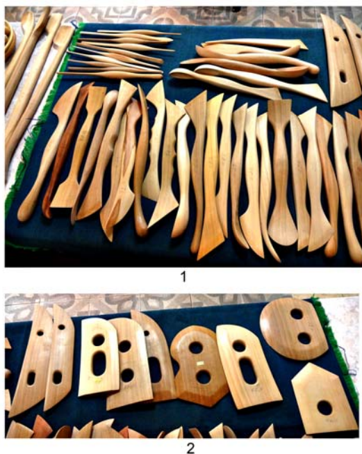
Рис. 4. Выставка-продажа современных деревянных универсальных инструментов гончара (Институт керамологии Отделения института народоведения НАН Украины, г. Опoшня): 1 – наборы разнообразных стеков; 2 – набор ножей (фото Л. Н. Мыльниковой)
