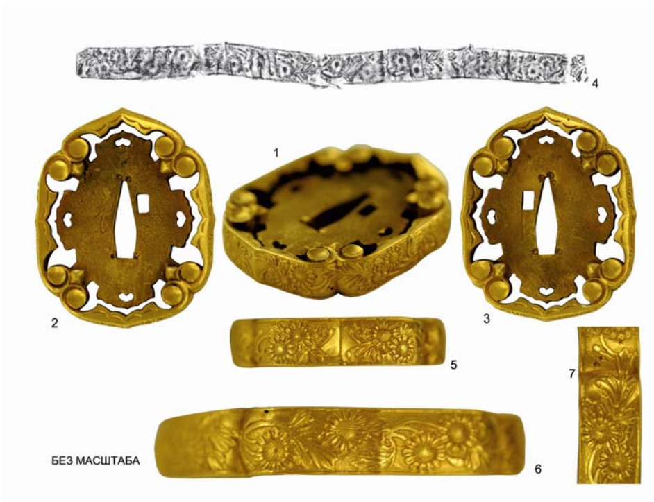
Рис. 7. Массивная гарда цуба : 1 – общий вид; 2 – аверс; 3 – реверс; 4 – копия рельефа торцевой поверхности цубы (микалентная бумага); 5 – фрагмент торцевой поверхности цубы ; 6 – фрагмент торцевой поверхности цубы с проявлениями усадочной пористости; 7 – проявления усадочной пористости (раковины на торцевой поверхности), покрытые позолотой (макросъемка)
