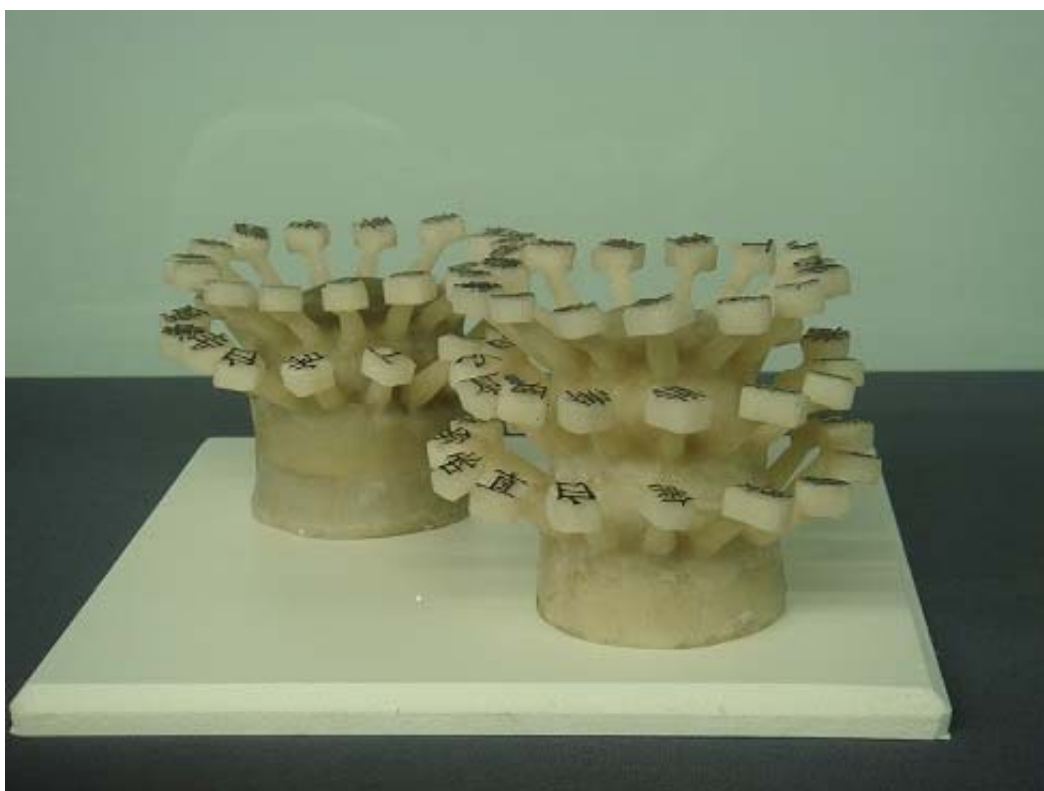
Рис. 2 (фото). Реконструкция восковых матричных ветвей для отливки литер, эпоха Чосон (Музей древнего книгопечатания в г. Чхончжу, Республика Корея)
