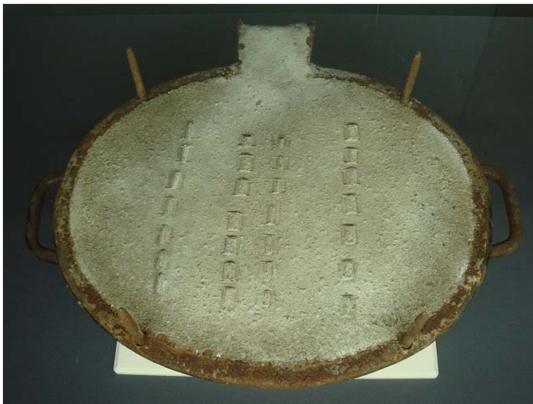
Рис. 4 (фото). Верхняя часть разъемной отливной металлической формы после извлечения готовой ветви с литерами, вторая половина эпохи Чосон (Музей древнего книгопечатания в г. Чхончжу, Республика Корея)
