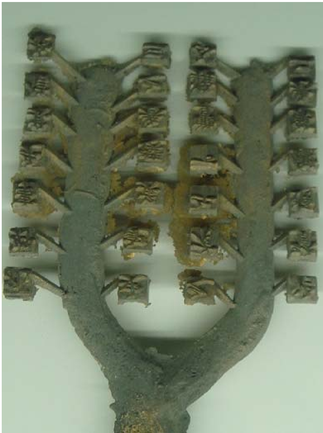
Рис. 6 (фото). Необработанная металлическая ветвь с литерами после извлечения из формы, вторая половина эпохи Чосон (Музей древнего книгопечатания в г. Чхонджу, Республика Корея)
