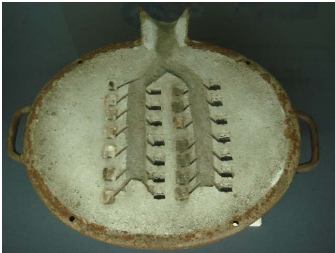
Рис. 5 (фото). Нижняя часть разъемной отливной металлической формы после извлечения готовой ветви с литерами, вторая половина эпохи Чосон (Музей древнего книгопечатания в г. Чхонджу, Республика Корея)
