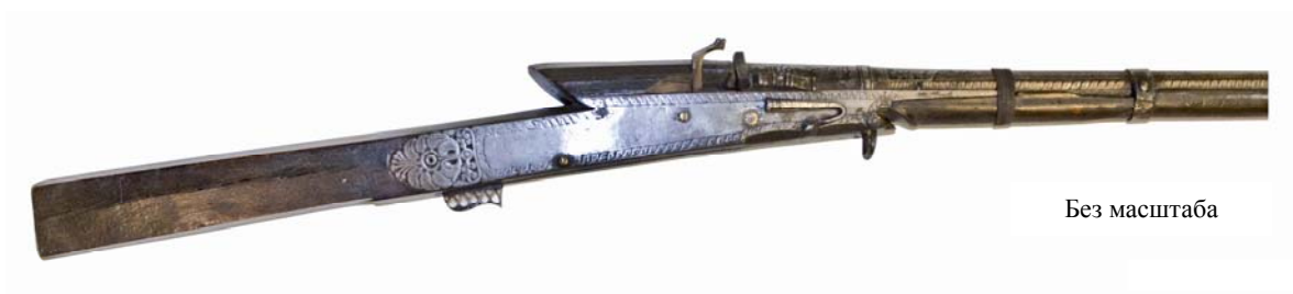
Рис. 4 (фото). Общий вид замка, замочной пластины, казенной части ствола, спускового рычага и приклада (без масштаба)
