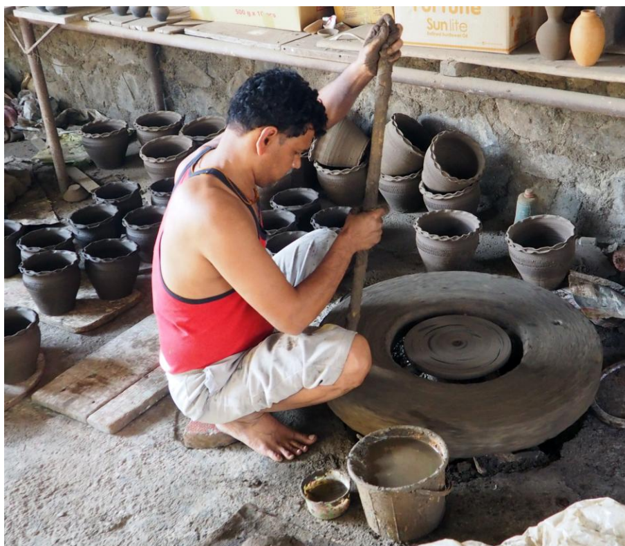
Рис. 5 (фото). Раскручивание ручного круга Fig. 5 (photo). Spinning of the traditional wheel
