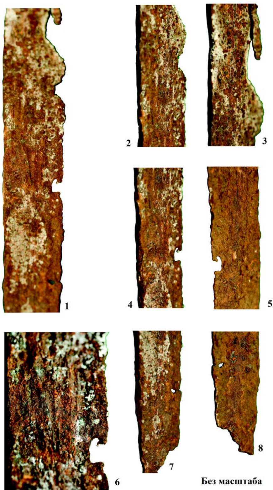
Рис. 3 (фото). Узор металла на клинке: 1 – общий вид узора ближней к острию трети клинка (увеличение, без масштаба); 2–5 – расположение полос узора на участках ближней к острию трети клинка (макросъемка, без масштаба); 6 – схождение полос узора металла клинка в пучок – «шпильку» (увеличение, макросъемка, без масштаба); 7 – сужение узора и соединение полос в пучок («шпилька») близ острия клинка, аверс (макросъемка, без масштаба); 8 – сужение узора и соединение полос в пучок («шпилька») близ острия клинка, реверс (макросъемка, без масштаба)
