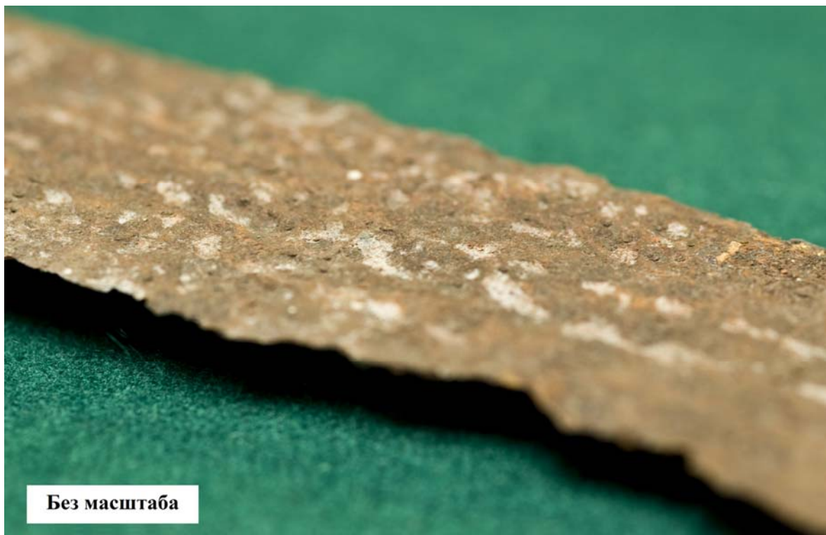
Рис. 6 (фото). Результат коррозии клинка палаша и повреждение узора металла – образование продольных канавок (увеличение, макросъемка, без масштаба; вид под боковым освещением)
