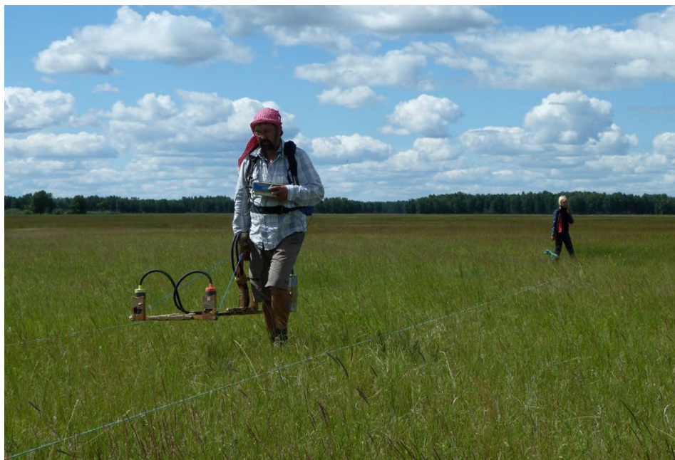
Рис. 4. Магнитная съемка на площади могильника Аул-Кошкуль-1 (полевой магнитометр SM4G-особенный Smartmag, Scintrex, Canada)
